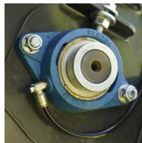
Les roulements externes réduisent le temps de maintenance.
