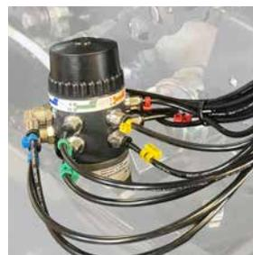
Lubrification automatique avec réglage possible du débit sortie par sortie.
