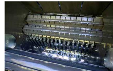
Les rouleaux agressifs assurent une formation instantanée des balles et sont équipés de racleurs autonettoyants conçus pour travailler dans des conditions de fourrage humide.
