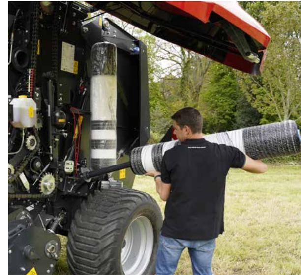
Le stockage ingénieux des rouleaux de filet permet un chargement horizontal confortable.
