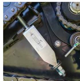
La tension des chaînes est facile à contrôler grâce aux repaires visuels.
