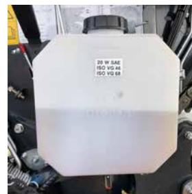
Réservoir de lubrification de grande capacité.
