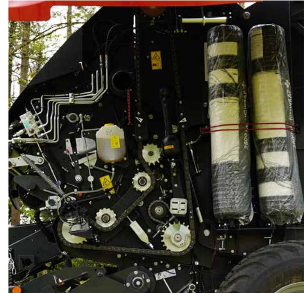
Le stockage vertical des rouleaux de filet permet un meilleur accès à la transmission de la presse.
