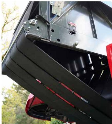
Les Densus 7060 et 7090 sont équipées de quatre courroies sans fin haute résistance, qui permettent une bonne mobilité de la balle et qui nécessitent peu d'entretien.
